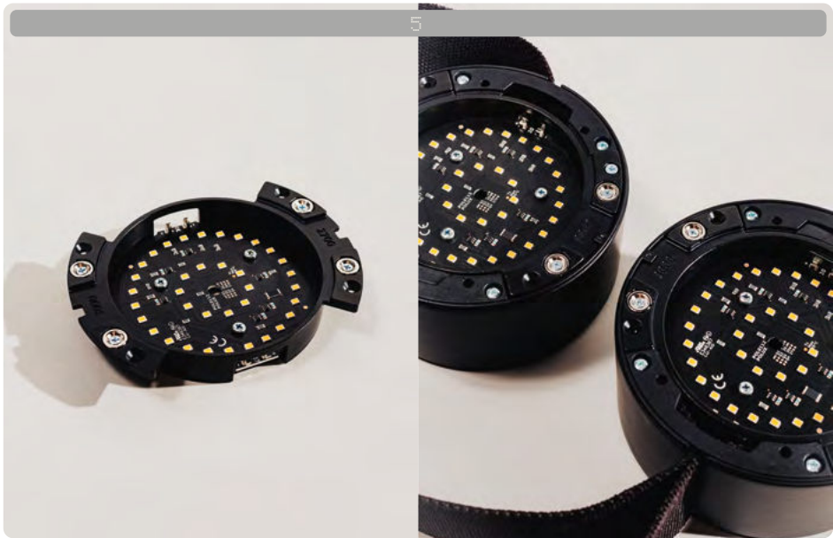
5 Turn the LED board and set it to the desired colour temperature (2700 or 3000 K). Ruotare la scheda LED e impostarla sulla temperatura di colore desiderata (2700 or 3000 K).
